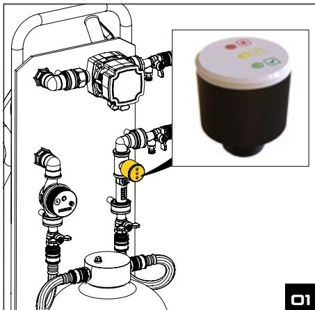
**DE:** Sobald die rote LED zu blinken beginnt, oder wenn der Inhalt des Filters bereits 2 Jahre alt ist, ist es Zeit, den Filterinhalt auszutauschen. Wenn eine Gesamtharte  $<0,5 \text{ °dH}$  eingehalten werden muss, müssen Sie den Filterinhalt schon beim Blinken der gelben LED tauschen.
