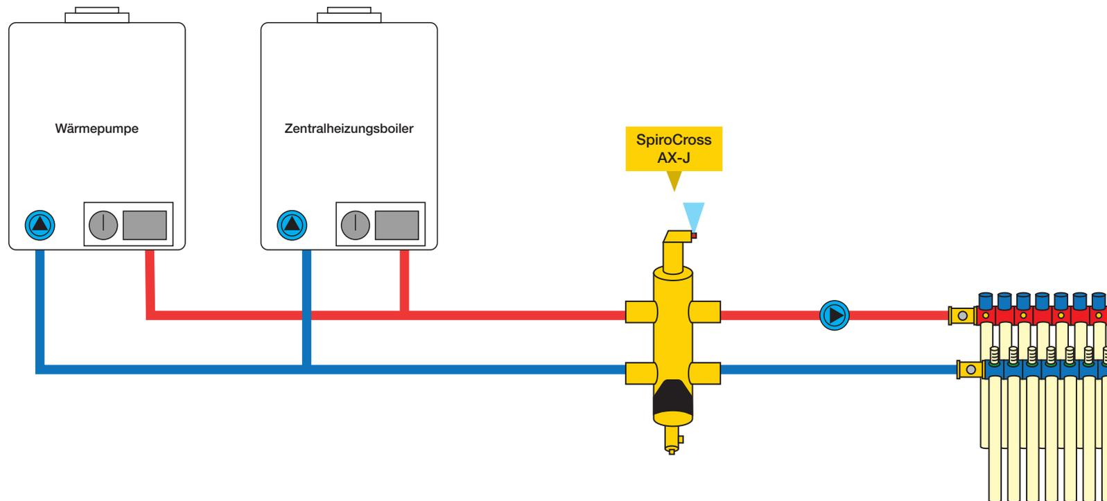
Diagramm - Hybrid-Wärmepumpensystem mit SpiroCross AX-J
