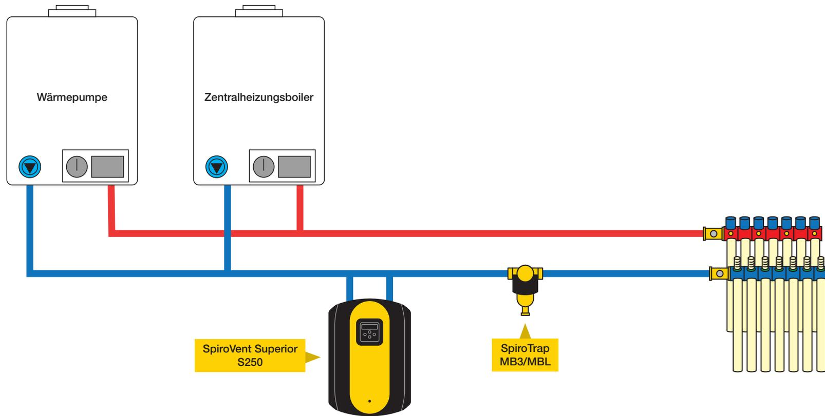
Diagramm: Hybrid-Wärmepumpensystem mit einem SpiroVent Superior S250 und einer SpiroTrap MB3/MBL
